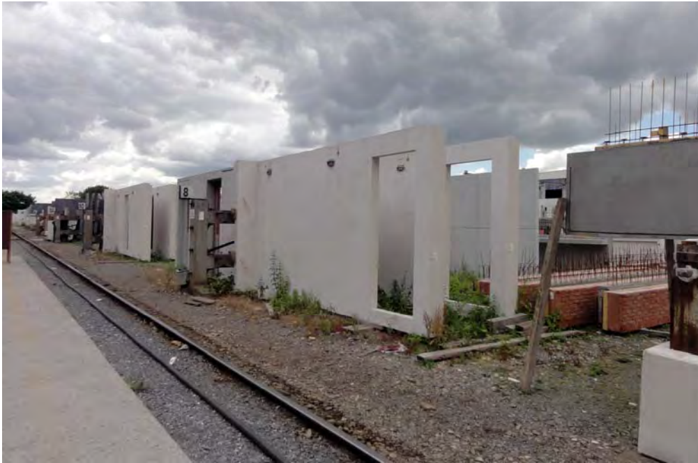
Éléments préfabriqués en béton chez Decomo en attente de départ
